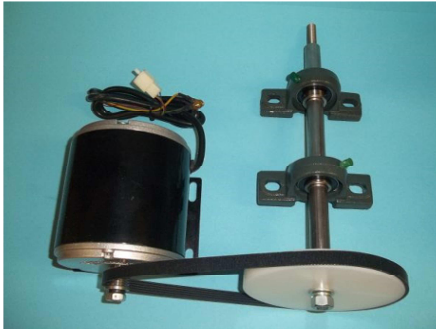
Abbildung 31: Permanent-erregter Gleichstromgenerator mit Übersetzung
