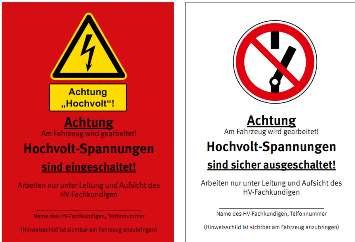
Abbildung 28: Warnhinweisschilder für das Arbeiten an Hochvolt-Fahrzeugen
