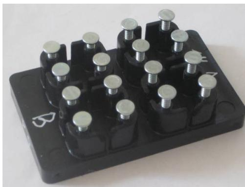
Bild 4.5 Testblock mit eingepressten Raststiften
