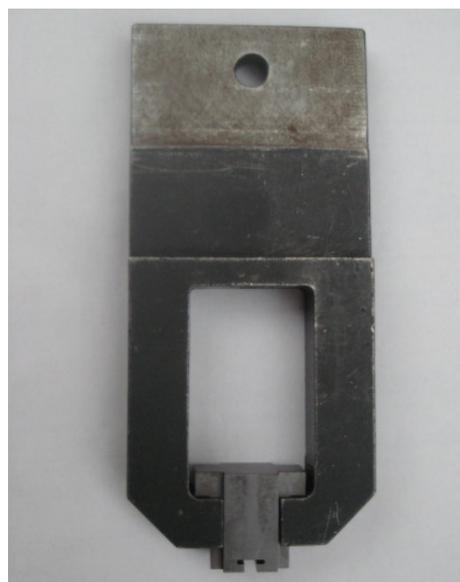
Bild 3.24 Abzugskralle mit eingelegtem Adapter
