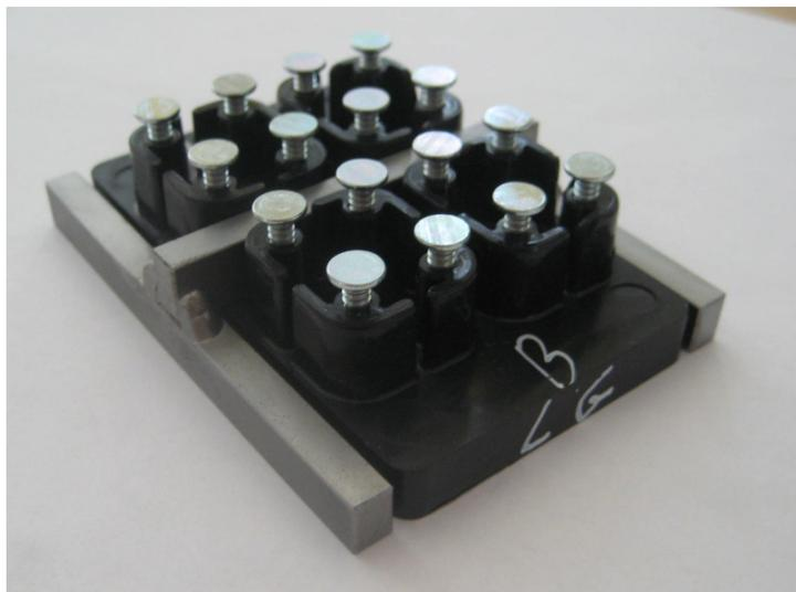
Bild 4.9 Testblock mit Niederhalter in Zugvorrichtung
