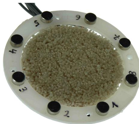
**Bild 2.1:** Mikrofonarray
