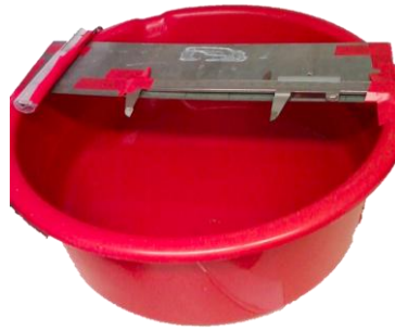
Abbildung 26: Wasserbecken mit Metallschiene und Schieblehre
