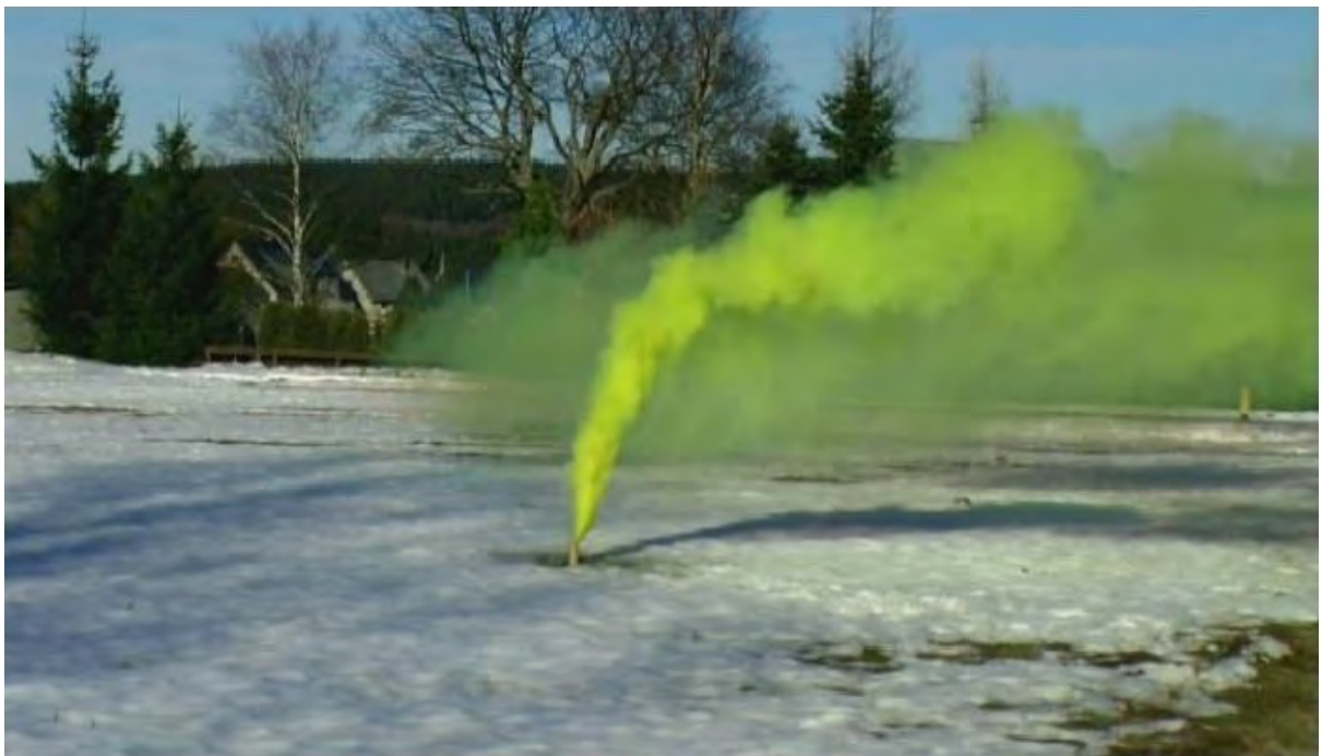
Abb. 20: Gelber Rauchtropf zur möglichen Darstellung von Chlorgas (Quelle: Wilhelm Beisel Pyrotechnik GmbH, Heidelberg [71])
