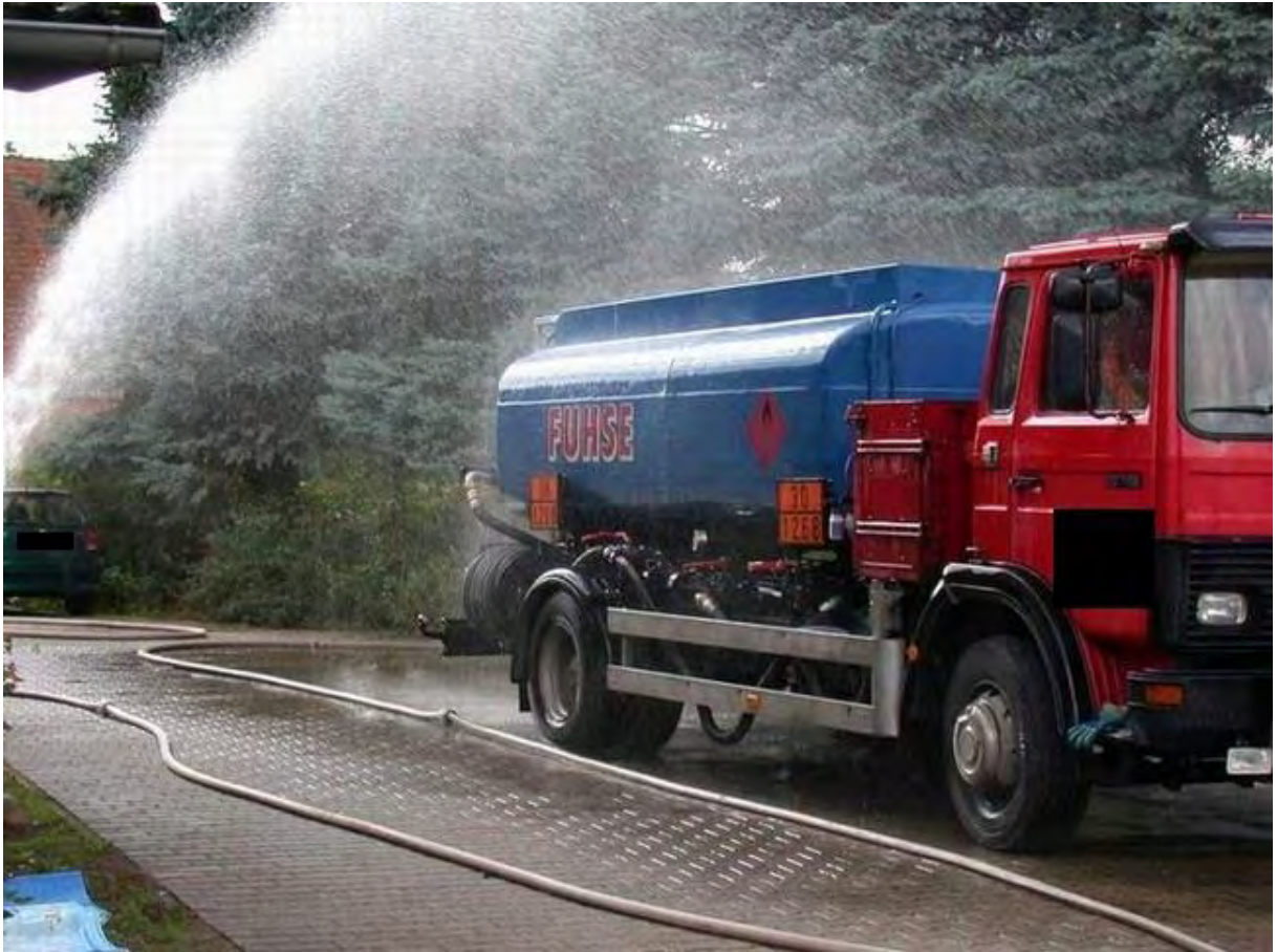
Abb. 6: Kühlung des betroffenen Tanklastwagens (Quelle: Verfasser nach [45])
