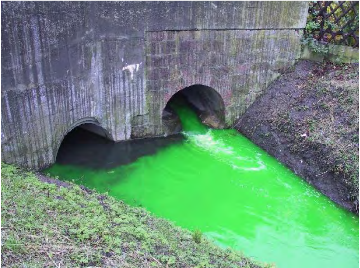
Abb. 16: Einsatzfoto der Feuerwehr Speyer, Vermutlich durch eine Überdosierung von Uranin und starken Regenfällen gelang eine Testmenge für Dichtigkeitsprüfungen eines Daches in einen Bachlauf (Quelle: Feuerwehr Speyer [65])
