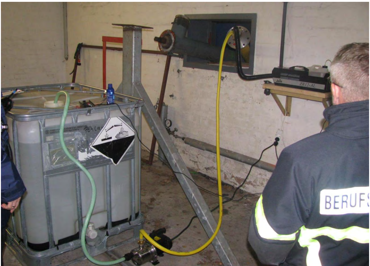
Abb. 18: Darstellung von Ammoniakaustritt mittels eingespeistem Nebelfluid und Wasser in ein Rohrleitungssystem (Quelle: Verfasser)
