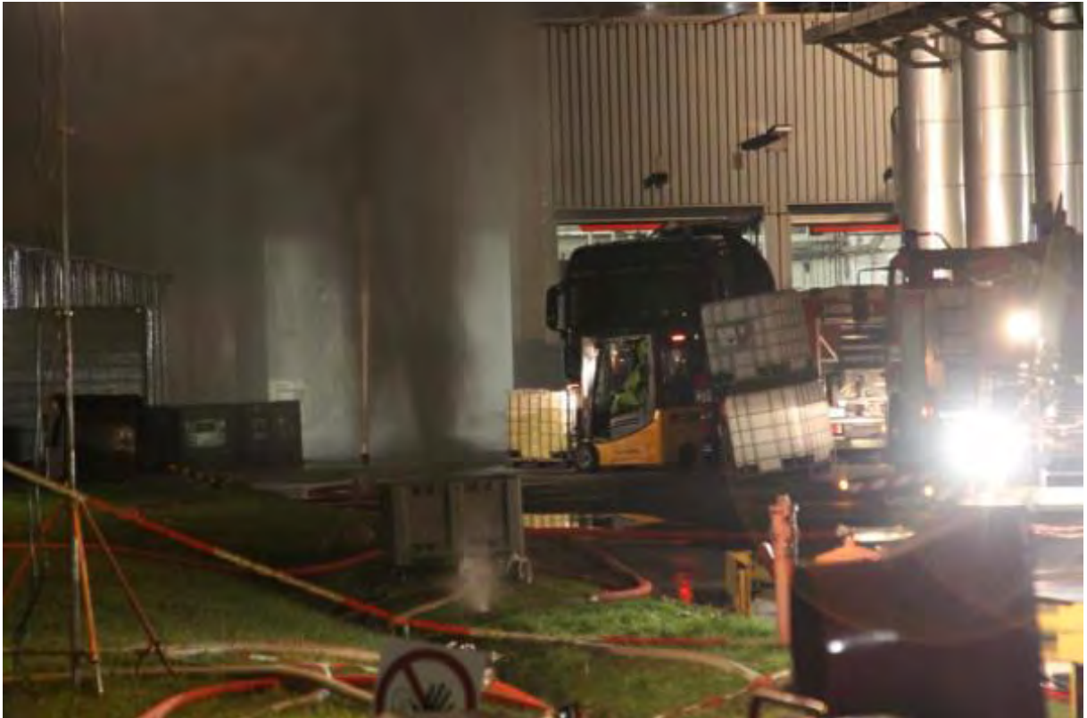
Abb. 9: Austretende Nitrose Gase aus einem IBC (Quelle: [49])
