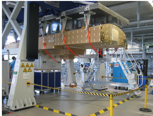
Abbildung 1.2: Crew-Bulk-Rest-Compartment am Vibro-Akustischen Prüfstand
