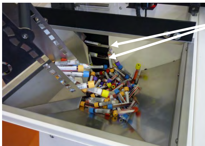
Abb. 2: Vereinzelung der Proben
