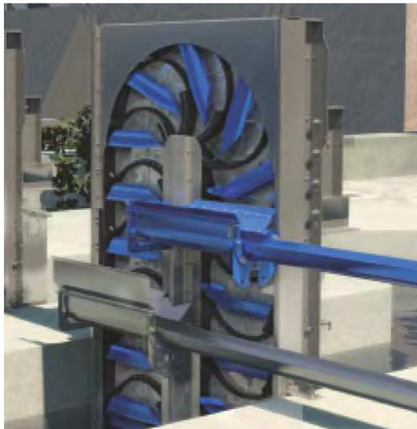
Abbildung 2.47 Multidisc-Anlage mit Fischrückführungssystem aus [58]
