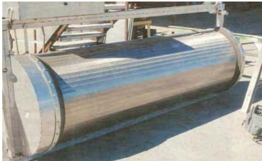
Abbildung 2.35 Trommelsieb aus gebogenen *Wedge-Wire-Screens* aus [17]
