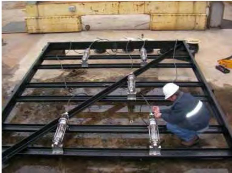
Abbildung 2.67 Stahlunterkonstruktion für Stroboskoplampen aus [68]
