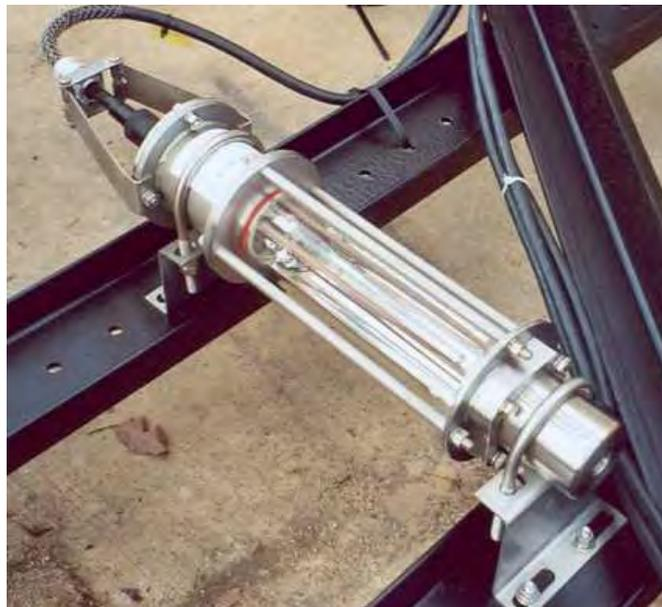
**Abbildung 2.69 Stroboskoplampen am Cumberland Fossil Plant aus [68]**
