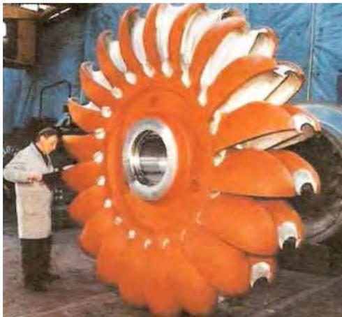
Abbildung 2.10 Peltonturbine aus [17]
