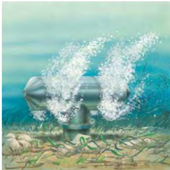
**Abbildung 2.33 Wedge-Wire-Screen an Gewässersohle aus [39]**
