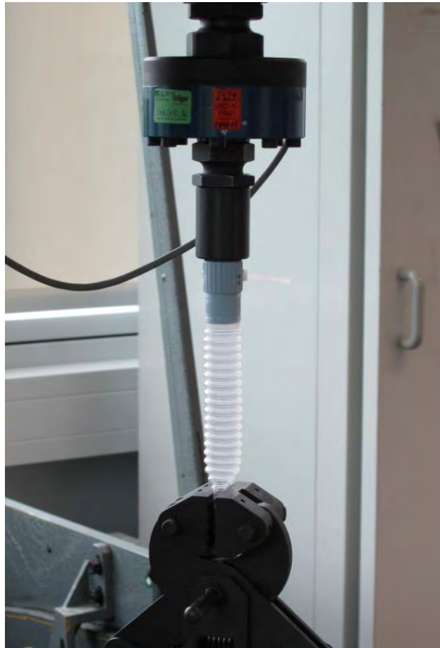
Abb. 2.5: Zugkraftmessung im TestCenter
