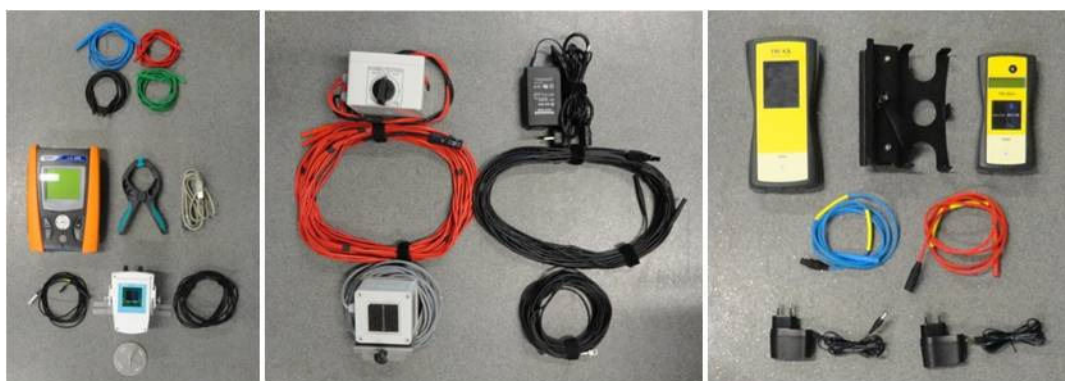
Bild 13: Messequipment (links I-V 400 , Mitte Profitest-PV und PVPM 1000CX , rechts TRI-KA )
