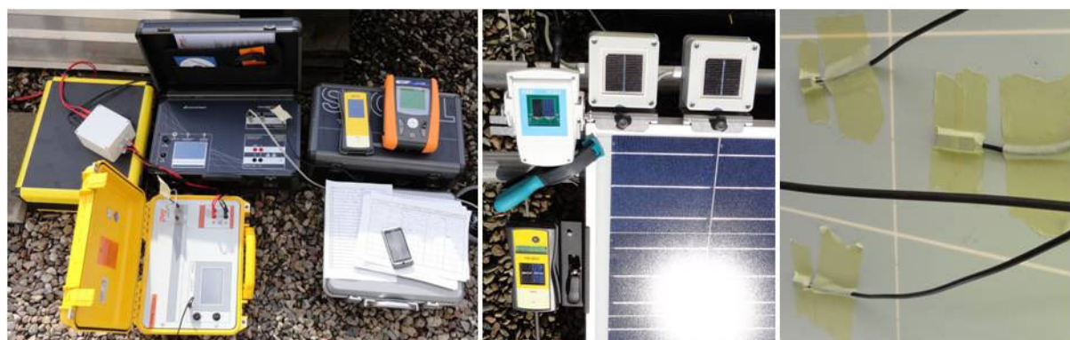
Bild 24: Messaufbau ( PVPM 1000CX , Profitest-PV , TRI-KA und I-V 400 ), Einstrahlungssensoren ( TRI-KA , I-V 400 , Profitest-PV und PVPM 1000CX ) und Temperatursensoren ( Profitest-PV , PVPM 1000CX und I-V 400 )(von links nach rechts)
