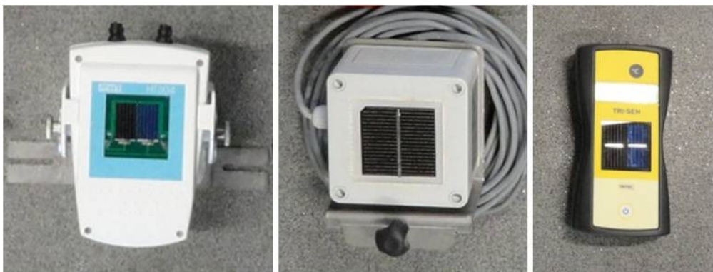
Bild 12: Einstrahlungssensoren (links das I-V 400 mit dem HT304 , Mitte das Profitest-PV und das PVPM 1000CX mit dem Phox , rechts das TRI-KA mit dem TRI-SEN )
