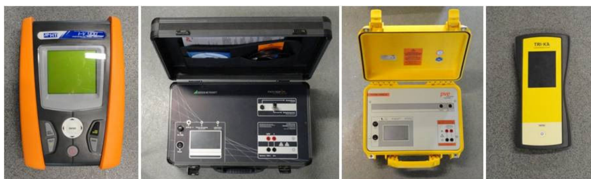
Bild 11: Messgeräte ( I-V 400 , Profitest-PV , PVPM 1000CX und TRI-KA )
