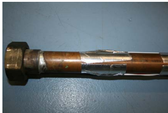
Abbildung 3.2: Sensoren auf der Ober- und Unterseite
