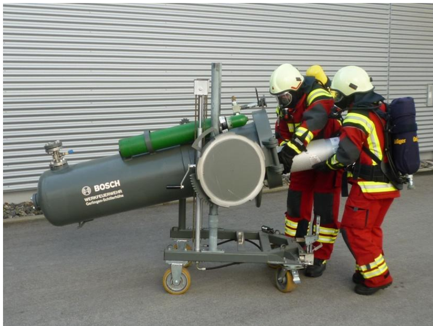
Abbildung 6: Gasflaschenbergebehälter am Standort Schillerhöhe 11
