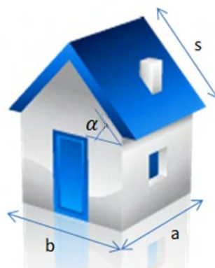
Abbildung 2.10.: Berechnung von Dachflächen bei Satteldächern
