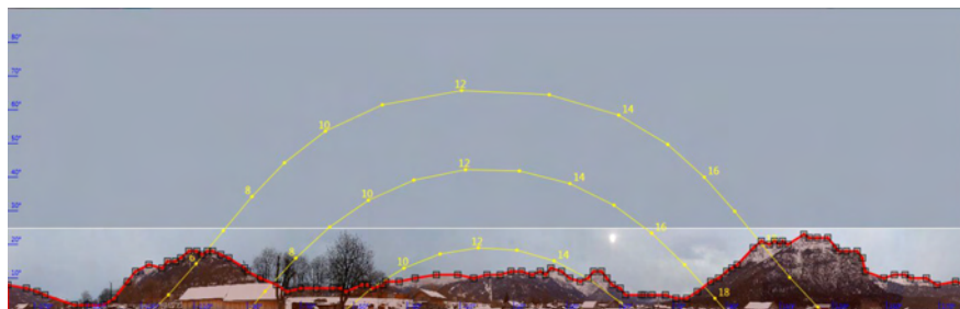
Abbildung A.4.: Sonnenstandsdiagramm der Verschattungszone 5
