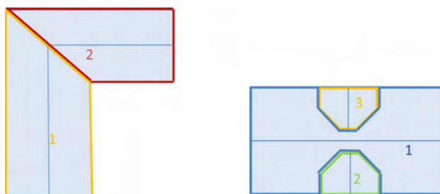
Abbildung 3.6.: Unterteilung von Dachflächen in mehrere Abschnitte
