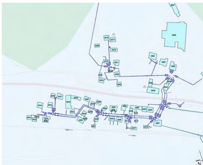
Abbildung 7.2.: Ergebnis der Aufbereitung des Niederspannungsnetzplans am Beispiel eines Ausschnitts des landwirtschaftlichen Gebiets((GP), (OSM13))
