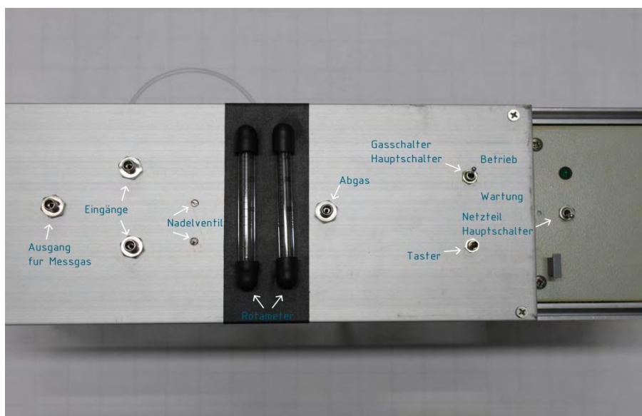
Abbildung 12 Photo des Gasverteilers von vorne
