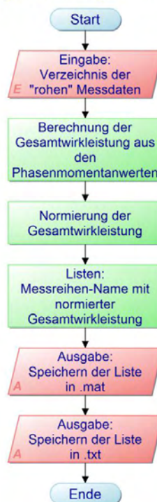
Abb. 12: Struktureller Aufbau der Wirkleistungsberechnung.
