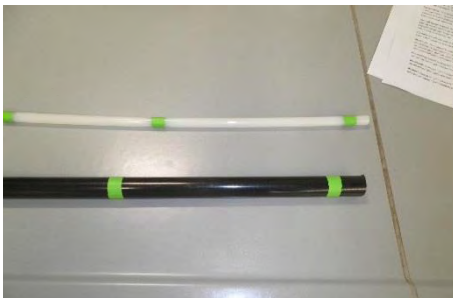
Abbildung 28: Fläche für den Dekontaminationsnachweis: 20 cm
