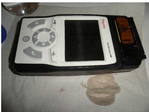
Abbildung 24: fertig dekontaminiertes Raman-Spektrometer
