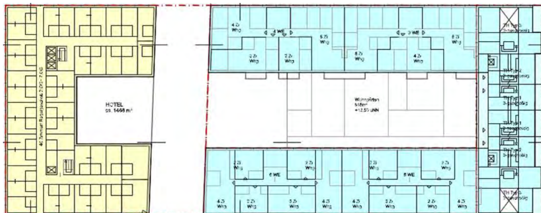
Abbildung 4-6: Grundriss von OG 2-6, Nutzung als Hotel (gelb) und Wohnung (blau) (Auslobung, 2013 S. 5)
