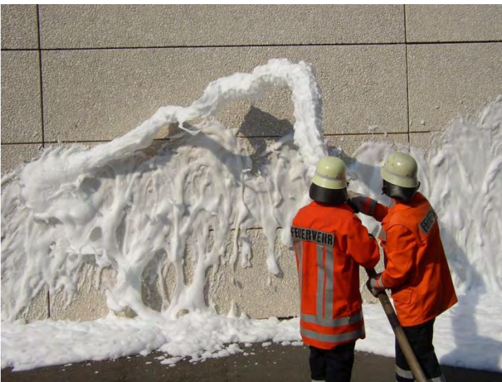
Abbildung 6: Haftwirkung Mittelschaum (Foto: N. Kramer)
