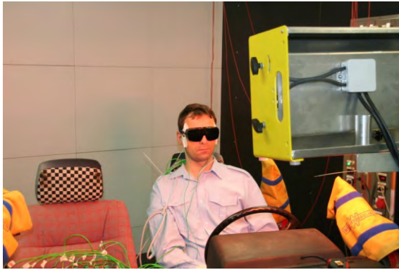
Abbildung 60: Proband 2 in der Erwärmungsphase mit dem Infrarotstrahler Abstand: 1,0 m
