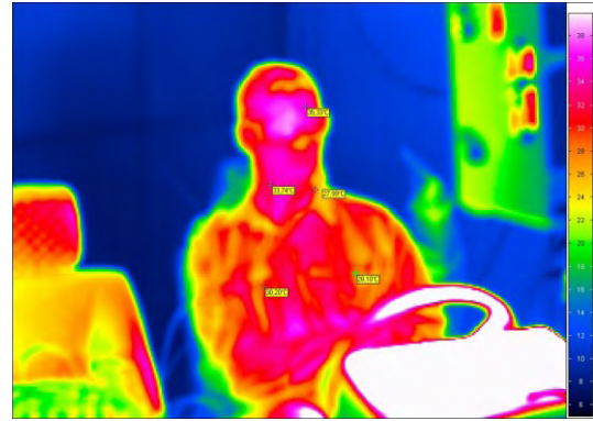
Abbildung 61: Infrarotbild: Proband 2 in der Erwärmungsphase mit dem Infrarotstrahler T_{\max} : Stirn = 35,33 °C
