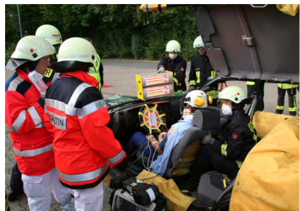
Abbildung 33: Erwärmung mit dem Infrarotstrahler von der Motorhaube. (Abstand ca. 1,0 m)
