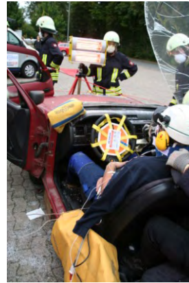
Abbildung 31: Erwärmung mit dem Infrarotstrahler auf einem Stativ vor der Motorhaube. (Abstand ca. 2,2 m)
