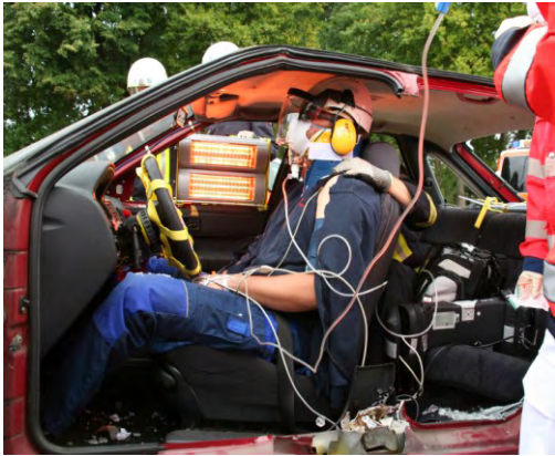
Abbildung 30: Erwärmung mit dem Infrarotstrahler durch die Seitenscheibe. (Abstand ca. 0,8 m)
