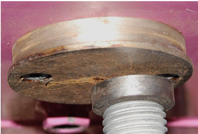
(b) Druckplatte und Justierbolzen
