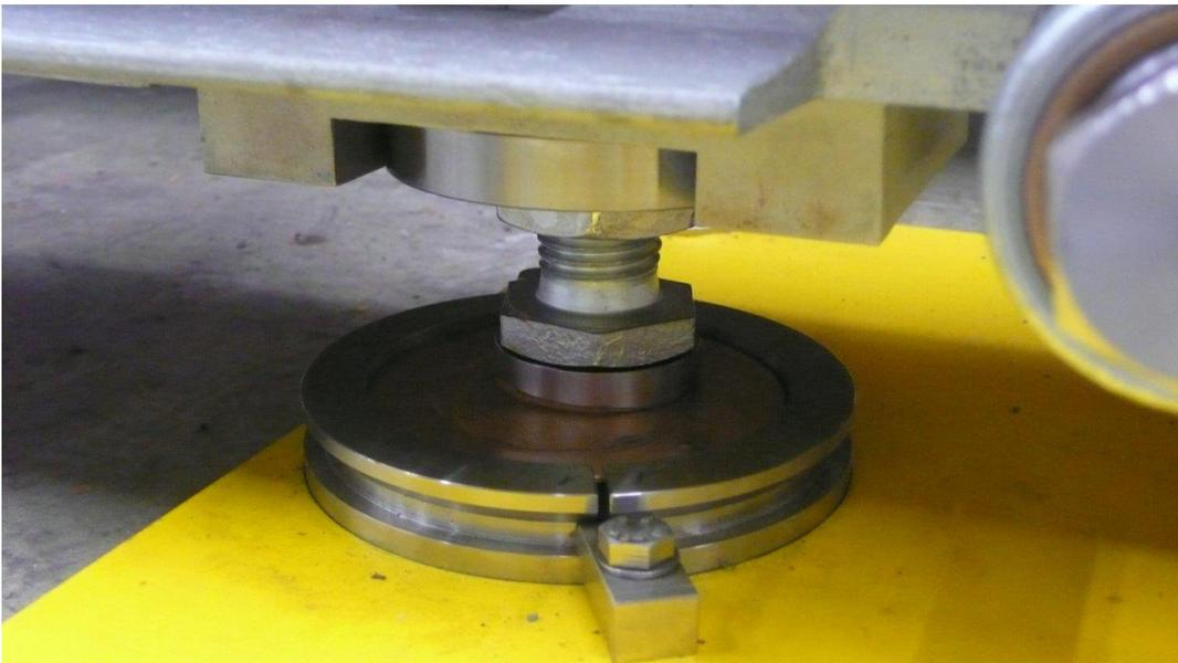
Abbildung B.8.: Justierelement einer Undulatoraufstellung mit Bronzescheibe, Kegelfanne und Kugelbolzen
