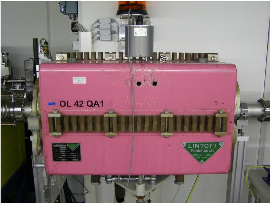
Abbildung B.2.: Aufbau der seismischen Messung auf dem Quadrupolmagneten OL 42 QA1
