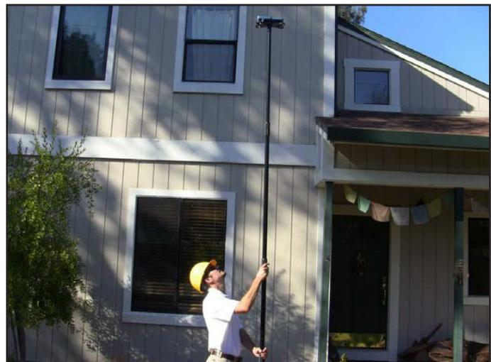
Das Extension Kit ermöglicht Dachmessungen vom Boden aus.
