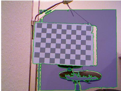
Abbildung 3.8: Ergebnis der Kalibrierung. Durch die Bestimmung der Kamera-Intrinsics und der Transformation zwischen den beiden Objekträumen der Kameras, lässt sich das Tiefenbild (hier blaue Überlagerung mit entfernten ungültigen Werten und grün hervorgehobenen Objektkanten) auf das Farbbild (hier Hintergrund) projizieren (Remapping).
