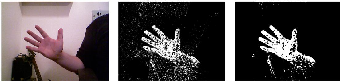
(a) Kinect-Aufnahme der Hand. (b) Hautfarbentest ohne vorangehende Filterung. Das Ursprungsbild der verwendeten Kinect ist stark verrauscht und rotstichig. Dieser Umstand könnte eine Vorfilterung der Aufnahme nötig machen. (c) Hautfarbentest eines Gauß-weichgezeichneten Eingabebildes. Weniger Bildrauschen führt zu besseren Ergebnissen.
