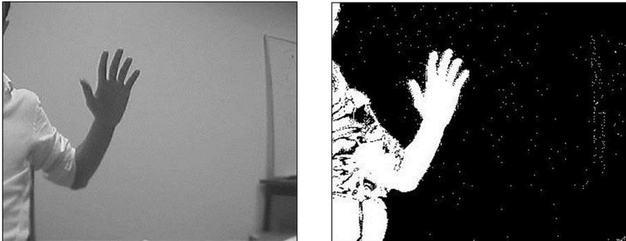
Abbildung 2.7: Background Subtraction (QUELLE: <http://e2e.ti.com>). Links: Eingabebild. Rechts: Binarisiertes Differenzbild.
