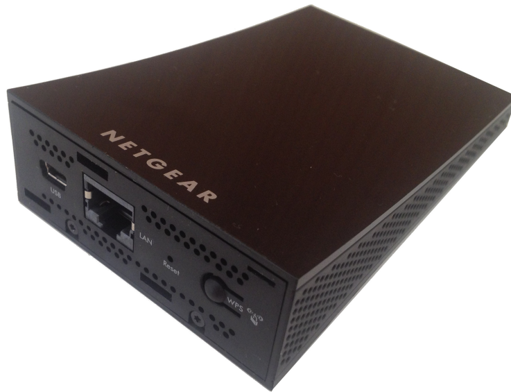
Abbildung 33: Netgear WNCE3001 verbindet die Ethernetschnittstelle der SoC-Plattform über ein WLAN-Netz mit dem 3D-Audio-Server
