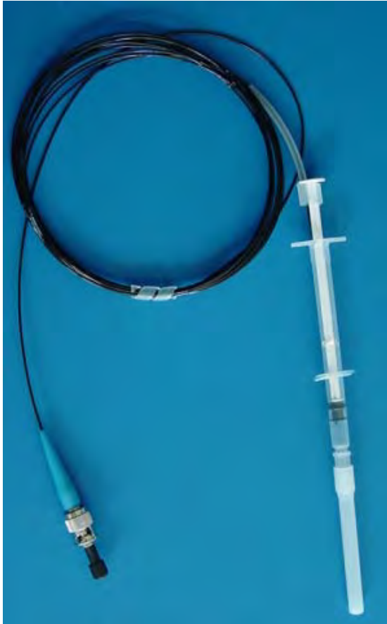
Abbildung 2.7 Sauerstoffsensoren mit Glasfaser (Huber & Krause, 2006)
