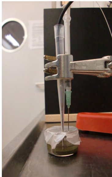
Abbildung 2.19 Temperatur- und Sauerstoffmessung im Überstandswasser des Schwebstoffs Bunthaus aus dem Monat März
