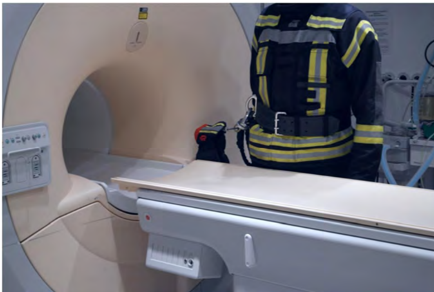
Abbildung 49 – Darstellung der Anziehungskraft am Einsatzhandschuh Modell Rosenbauer. Der Handschuh wird aufgrund des Magnetfelds in Richtung der Röhre der MRT gezogen und durch das Tragesystem zurückgehalten. 25
