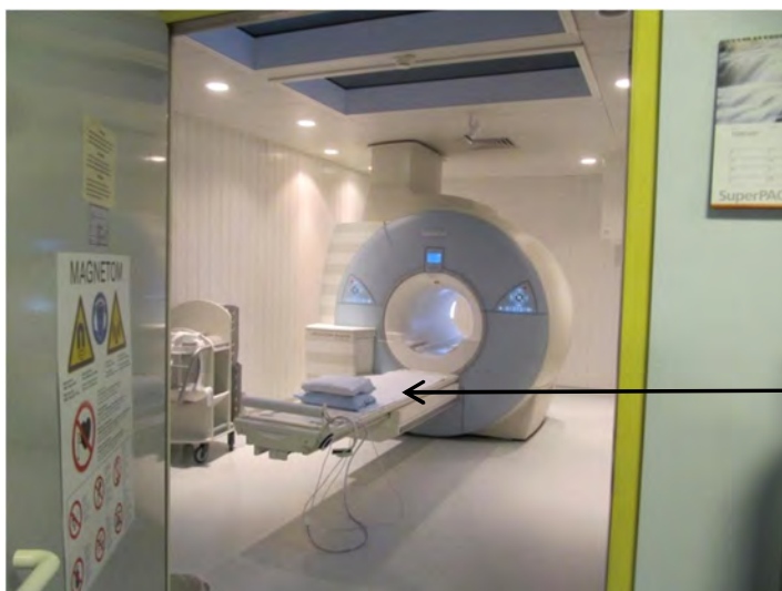
Abbildung 15 – Magnet eines 1,5 Tesla MRT-Systems (Magnetom Avanto) der Fa. Siemens 18
