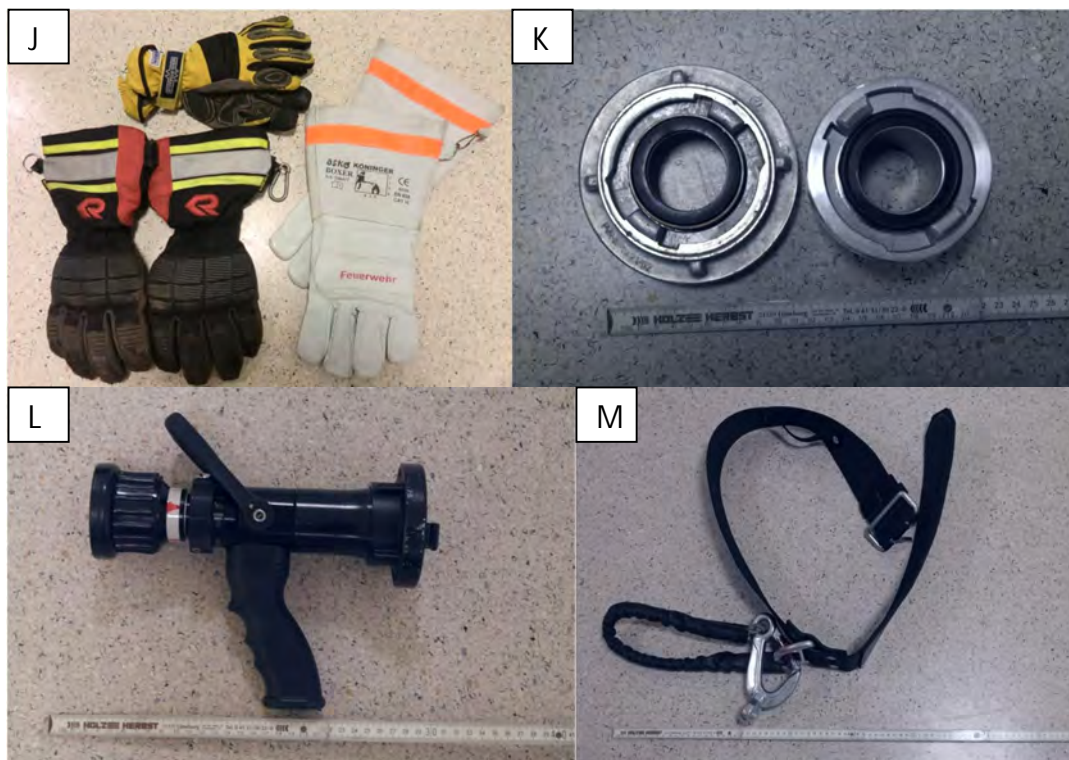
Abbildung 7 – Testobjekte der Feldstudie von links nach rechts: Einsatzhandschuhe (J), Übergangsstück und C- Kupplung (K), Hohlstrahlrohr (L), Feuerwehrhaltegurt (M). 13
