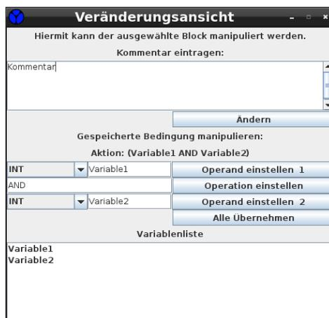
Das Veränderungs Fenster passt sich dabei an die verschiedenen Knotentypen an, sodass diese sinnvoll manipuliert werden können. In diesem Fall ist im unteren Bereich eine *JList* mit den bereits vorhandenen Variablen zu sehen und darüber die Möglichkeit, durch *JTextField* die verschiedenen Felder und die Operation der Bedingung zu ändern. Im oberen Abschnitt kann ein Kommentar eingetragen und über „Ändern“ gespeichert werden.
