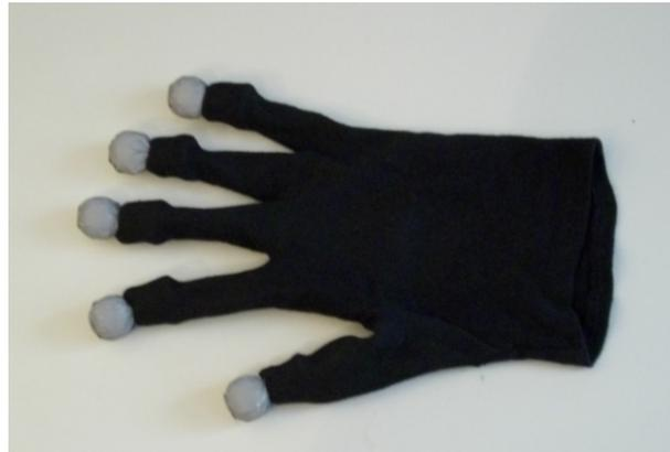
Abbildung 4.2: : Selbstgebauter Handschuh mit Markern
