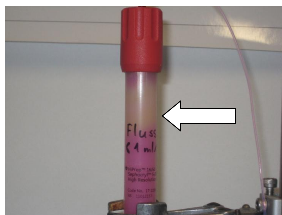
Abbildung 2.2: Mit Ingwer-Extrakt beladene Säule
