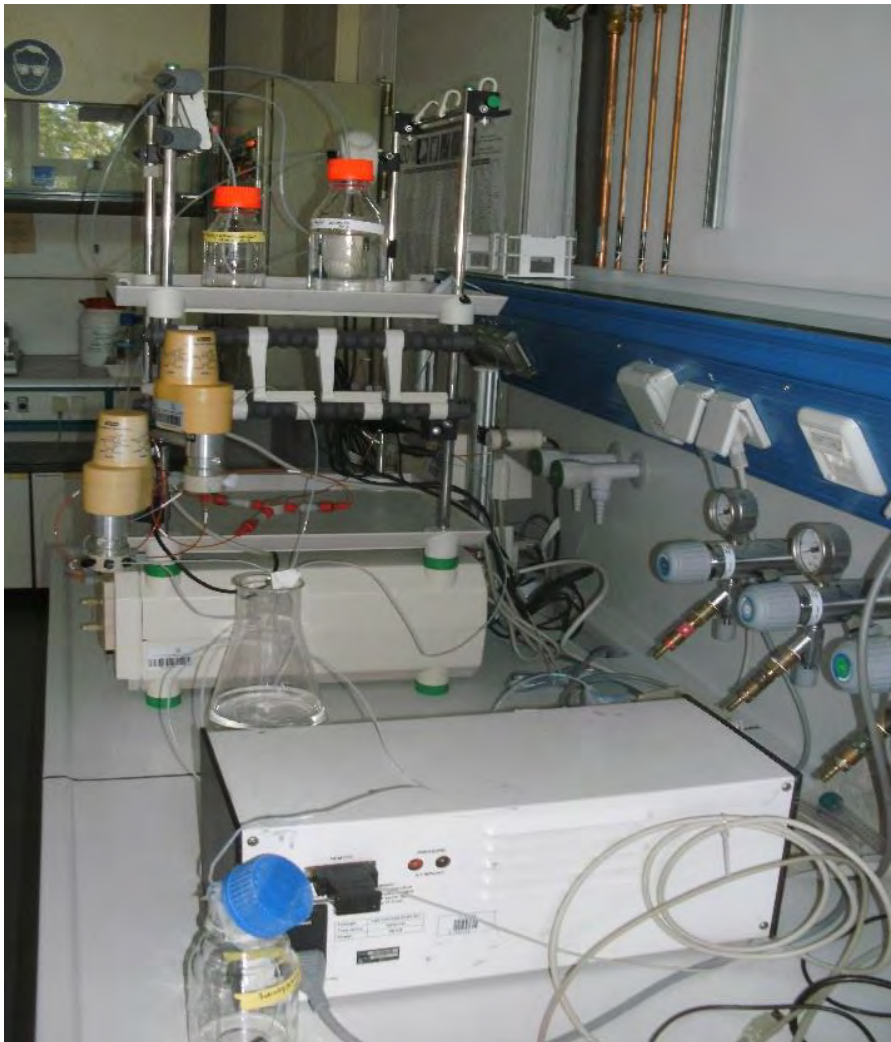
Abbildung 4: Übersicht der verwendeten Bio Rad HPLC Anlage mit zwei Ventilen, drei Säulen und einer P-500 Hilfspumpe für die automatische Probenaufgabe.
