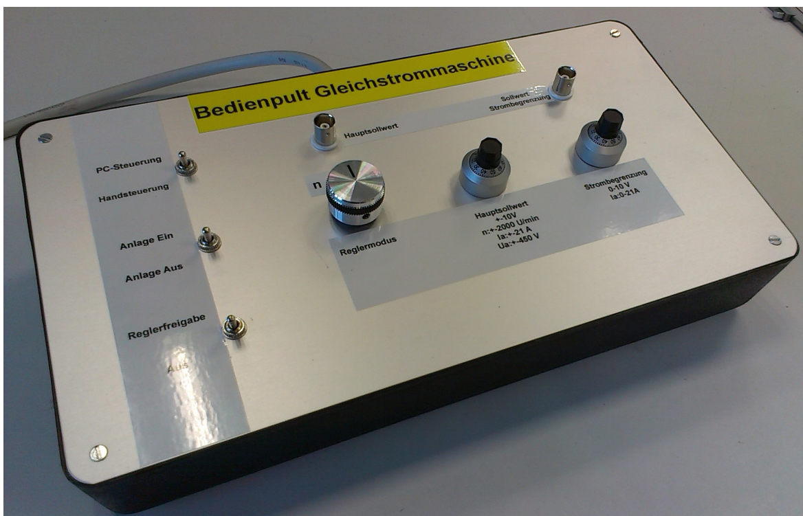
Abbildung 4.21: Bedienpult des Schaltschranks
