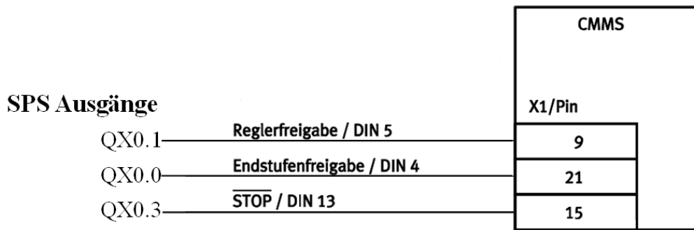
Abbildung 6-7 Anschluss des Controllers an SPS
