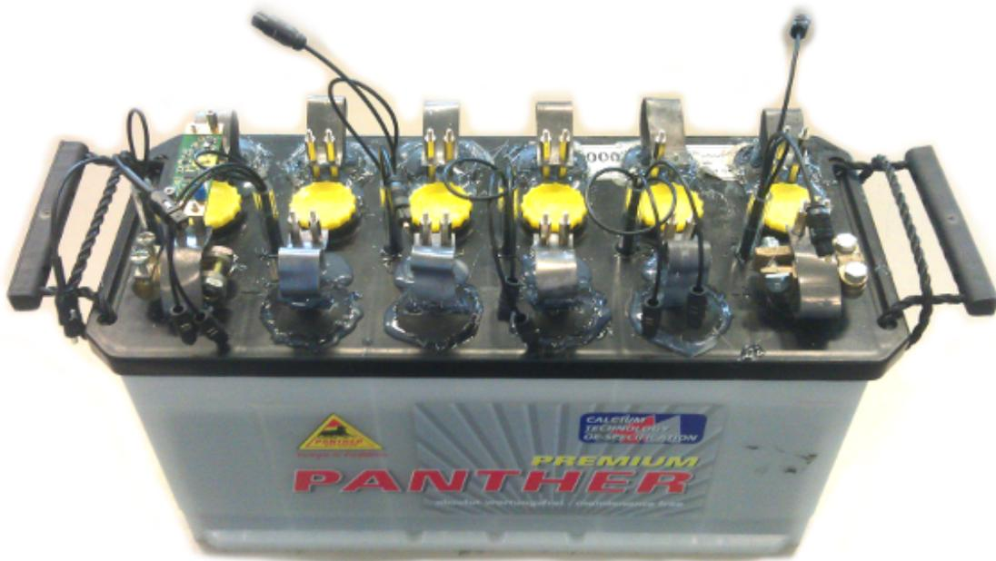
Abbildung B.2: Präparierte Bleibatterie Panther Premium nach Nasimzada [21]. Dieser Batterietyp wurde verwendet. Es können Klasse-1-Sensoren auf die Zellenpole montiert werden. Zusätzlich befinden sich nicht verwendete Toslink-Stecker an der Batterie, die für die optische Messung des Brechungsindex gebraucht werden.
