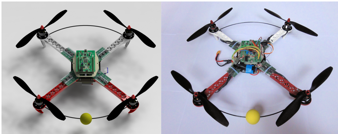
Bild 3.7: Vergleich zwischen 3D-Modell (links) und realem Modell (rechts)
