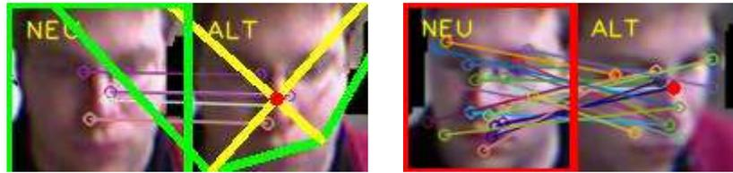
**Bild 5.38:** Tracking einer Person – SURF-Gesichterabgleich (links positiv, rechts negativ)
