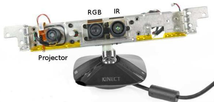
**Bild 2.3:** Komponenten des unverkleideten Kinect-Sensors, Quelle [10]
