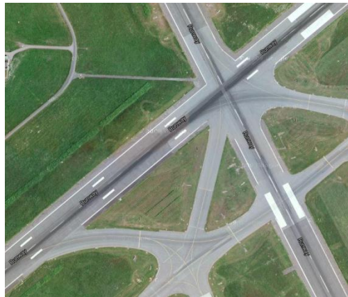
Abbildung 17. Spuren des Reifenabriebs auf den Flugbetriebsflächen des Flughafens Hamburg. (Quelle: Google maps)
