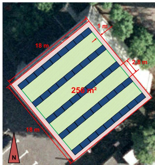
Abbildung 4.9.: Aufstellfläche, Ausrichtung und Anordnung der Kollektorfelder auf dem Dach des Bunkergebäudes
