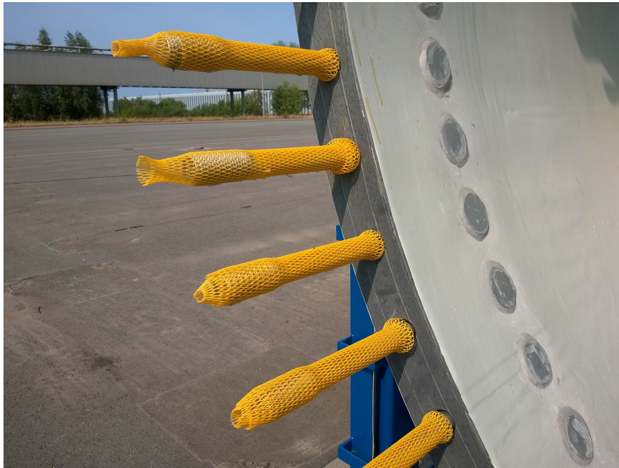
Abbildung 2.4.: T-Bolzen eines Rotorblattes (M5000-116, AREVA Blades GmbH)
