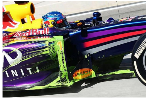
Abb. 58 Flow-Viz Farbe (neongrün) am Seitenkasten zur Visualisierung der Oberflächenströmung [MOT14]
