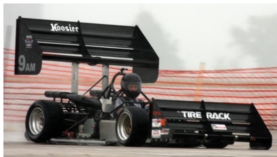
Abb. 93 A-Mod Fahrzeug für die Solo Nationals der SCCA, eine Rennveranstaltung für Amateure auf engen, mit Pylonen abgesteckten Kursen. Neben den großen Flügeln verfügt dieses Fahrzeug über Venturi Tunnel und flexible Schürzen [F1T14] SCCA steht für Sports Car Club of America und ist Veranstalter diverser Amateurrennveranstaltungen.
