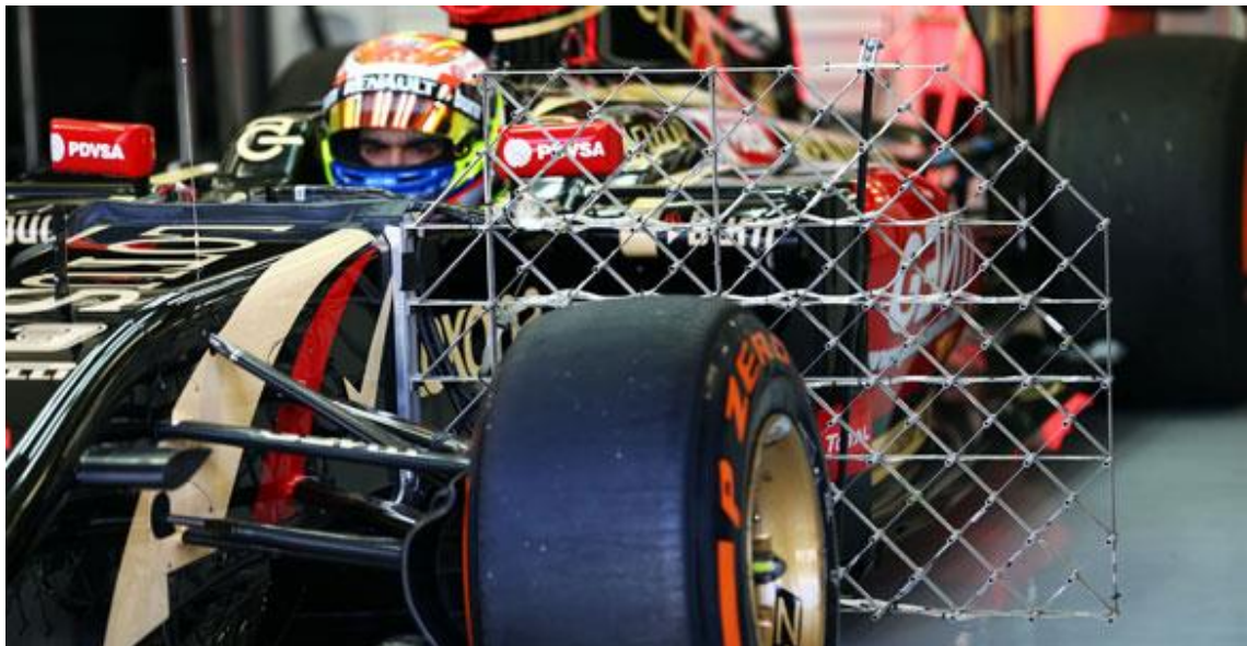
Abb. 59 Komplexe Messeinrichtung zur Aufnahme der Druckverhältnisse im oberflächenfernen Bereich [MOT14]
