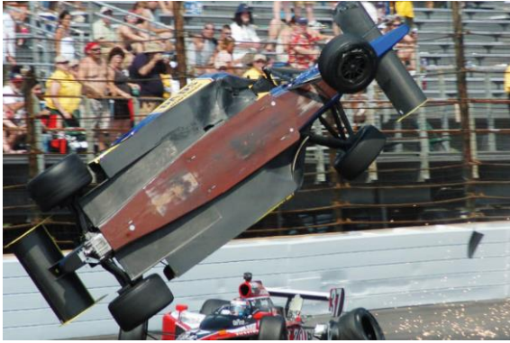
Abb. 48 Diffusor an einem Indy Car hinter einem ebenen Boden [PIC10]
