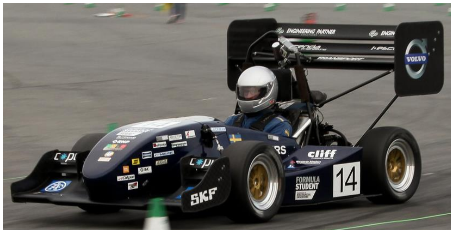
Abb. 99 Beispiel für die Unterschätzung der Wichtigkeit eines bewegten Bodens für eine Simulation. Das Chalmers FSAE Team musste in ihrem ersten Jahr mit Aerodynamik mit einem deutlich steiler angestellten Frontflügel im Vergleich zum Heckflügel fahren, um die Balance im fahrbaren Bereich zu halten [FSG13]
