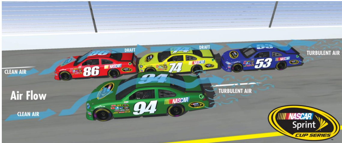
Abb. 11 Darstellung des Windschattens anhand der NASCAR Rennserie [NAS12]
