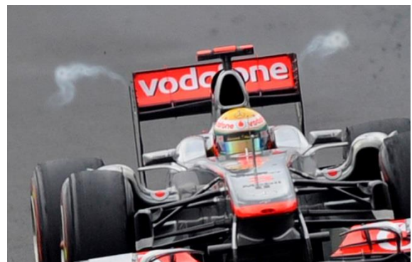
Abb. 98 Bei hohen Geschwindigkeiten auftretende, viskose Effekte, bei denen der Druck so niedrig ist, dass die Luftfeuchtigkeit sichtbar kondensiert. [PIS09] [SCA11]
