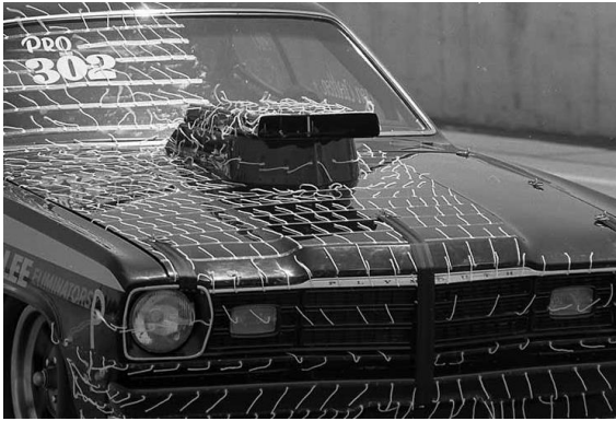
Abb. 57 Wolffäden zur Visualisierung der Oberflächenströmung [ECO13]
