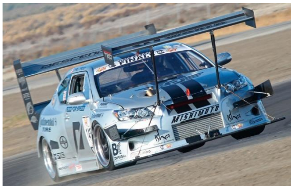
Abb. 90 Auf maximalen Abtrieb ausgelegter Mitsubishi Lancer. Man beachte den hochangebrachten Frontflügel [IMP14]
