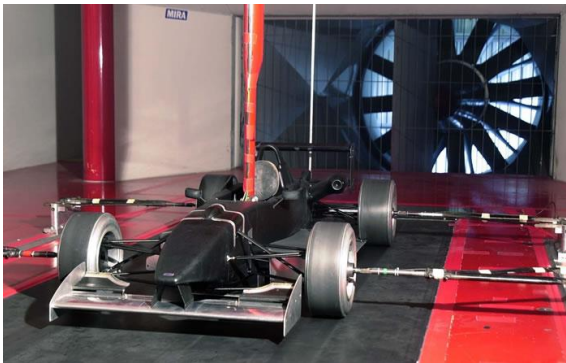
Abb. 60 Windkanalversuch mit dem Modell eines Rennfahrzeugs. Das Modell ist an einem Messarm (rot dargestellt) aufgehängt, der Kräfte und Momente bezüglich der drei Achsen des Schwerpunkts aufnimmt. Der Boden ist beweglich ausgeführt und die Räder drehend [AUT10]
