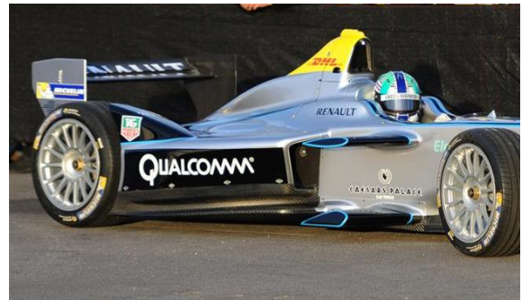
Abb. 53 Flügelartige Vortexgeneratoren an der Seite eines Formel E Boliden. Die Profile sind wie an einem Flugzeug angeordnet und produzieren an sich Auftrieb. Durch das Fehlen einer Seitenplatte entsteht ein Wirbel an der Flügelspitze, der den Unterboden, bzw. den Heckflügel verbessern soll [TZM14]
