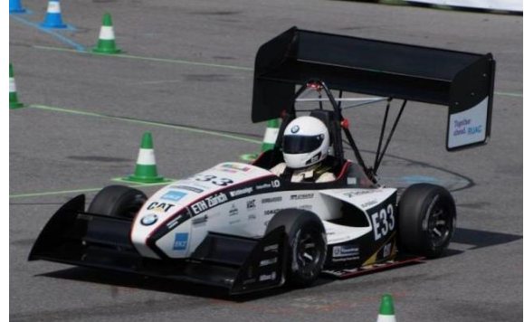
Abb. 74 Sehr ähnliches erstes Aerodynamikpaket des AMZ Racing Teams 2012 [FSG13]
