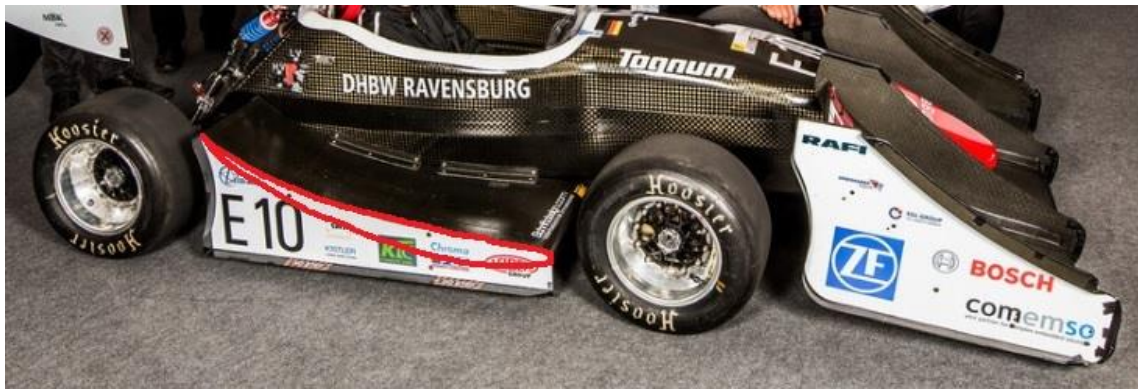
Abb. 80 Flügelseitenkästen am Elektrofahrzeug des Global Formula Racing Teams. Bei diesem Elektrofahrzeug entfallen Kühler und Abgaskrümmner in den Seitenkästen. [FSG13]
