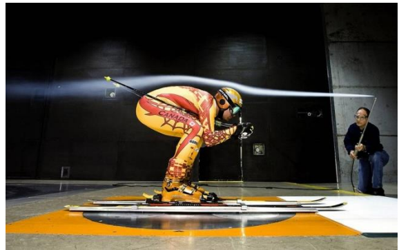
Abb. 61 Strömungsvisualisierung mittels Rauchsonde im Windkanal [AUT10]
