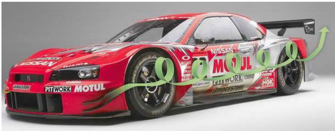
Abb. 56 Durch Tauchplatten verursachter Wirbel zur Unterdrückung des Druckausgleichs zwischen Fahrzeugoberseite und -Unterseite [FOR14]
