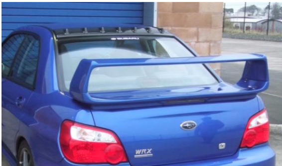
Abb. 52 Spitze Vortexgeneratoren an der Dachhinterkante eines Subaru Impreza. Die Vortexgeneratoren reichern die Strömung mit kinetischer Energie an, damit diese an der Karosserie anliegt und den Heckflügel effizienter macht [NAS09]
