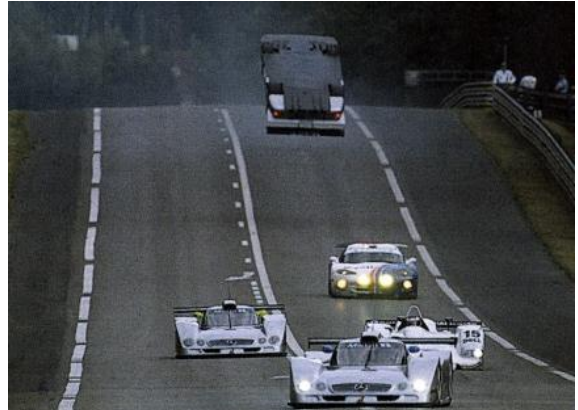
Abb. 16 Überschlag eines der drei auf gleiche Weise verunglückten Mercedes Benz CLR beim 24 Stunden Rennen in Le Mans 1999 [FUL11]
