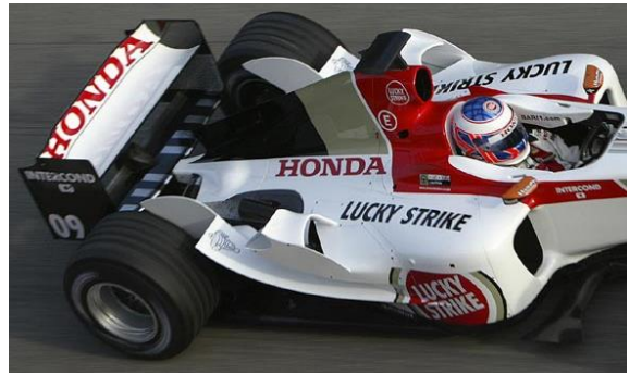
Abb. 55 Große Tauchplatte vor den Hinterrädern des BAR Honda F1 zur Reduzierung des Widerstands der Hinterräder und Produktion von Abtrieb [ULT07]
