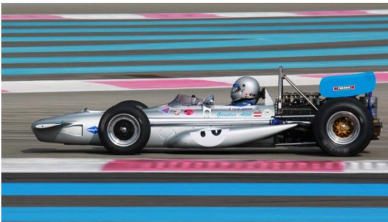
Abb. 46 Flügelartige Seitenkästen am March 701 von 1970 [F1F13]
