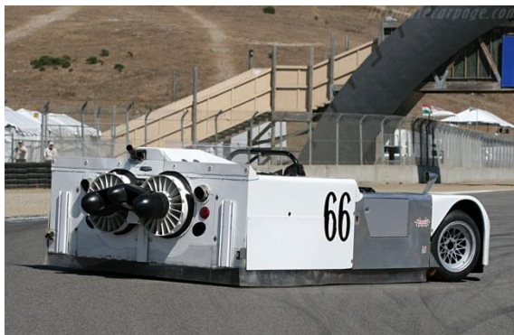
Abb. 42 Chaparral 2J mit Gebläse am Heck und Gummischürzen [CLO13]
