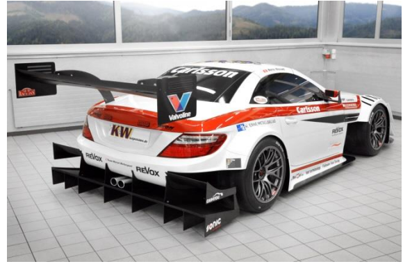
Abb. 49 Komplexer Diffusor am Heck eines Carlsson SLK [AUT14]
