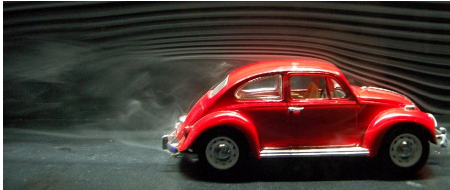
Abb. 41 Darstellung des Niederdruckgebiets im Totwasser hinter einem Fahrzeug anhand eines Windkanalversuchs mit Rauchlinien [SPE14]
