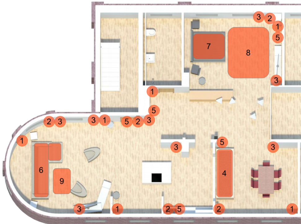
Abbildung 2.2: Laborsensorik im Wohnbereich des Living Place Hamburg: [1] Positionserkennung [2] Kameras [3] Kabelloses Sensornetzwerk [4] Multitouch-Tresen SiBar [5] Mikrofone [6] Couchsensorik [7] Intelligentes Bett [8] Sturzerkennung [9] Multitouch Tisch [Otto (2013)]
