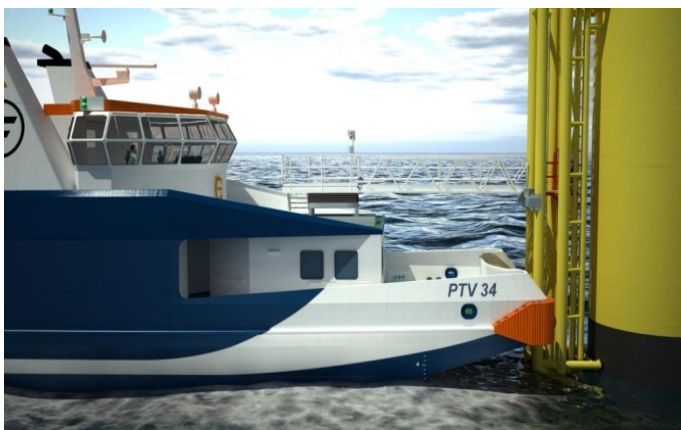
Abbildung 17: Fassmer, Safty Access System
