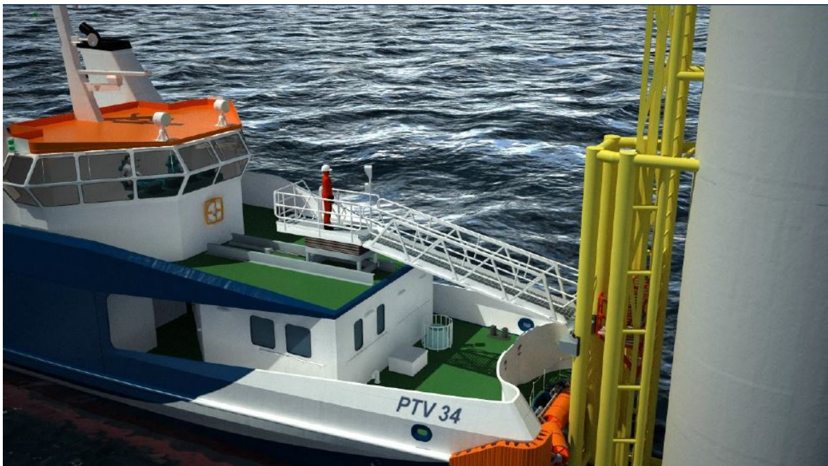
Abbildung 18: Prinzipdarstellung des Überstiegssystems auf einem CTV 24
