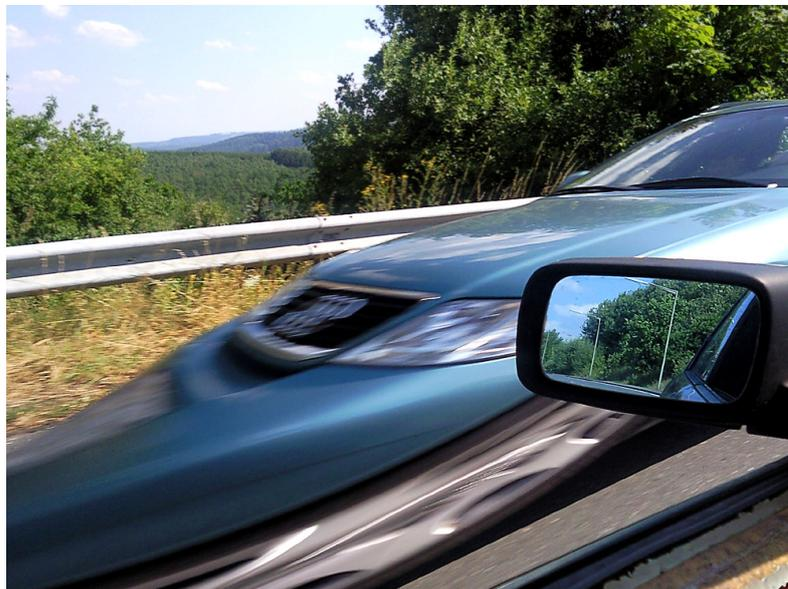
Abbildung 12.2.: *Rolling shutter* Effekt bei einem bewegenden Motiv. (Axel1963 (2010))
