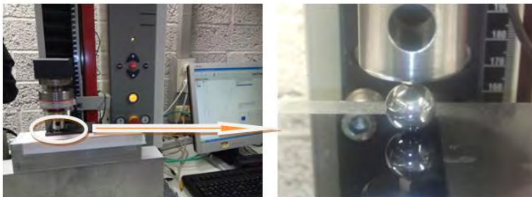
ABB. 13: FOTOGRAFISCHE AUFNAHME DES VERSUCHSAUFBAUS ZWICK 0,5 KN.
