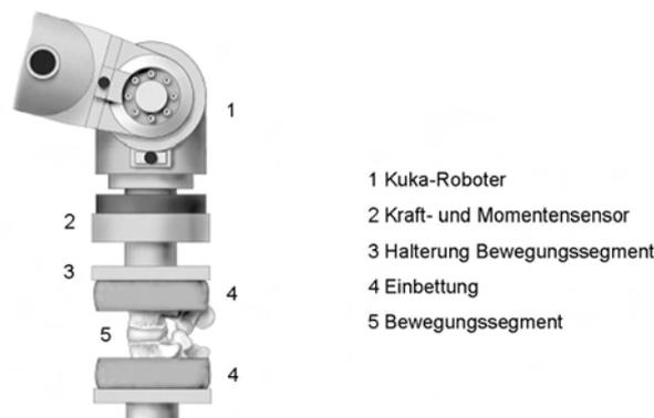
**Bild 3.8** Schematische Darstellung eines Versuchsaufbaus mit dem Kuka-Industrieroboter und monosegmentalen Wirbelsäulenpräparat.
