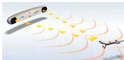
**Bild 3.11** Darstellung des NDI-Systems. Der Kamerabalken entsendet IR-Licht, die Linearprobe reflektiert das IR-Licht zum Kamerabalken und nimmt das Signal auf [NDI12].
