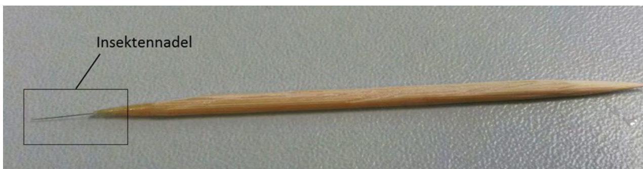
Abbildung 21: Speer aus Insektennadel und Zahnstocher. Um die DiI-Kristalle an dem Gehirngewebe zu befestigen, wurde aus einer kleinen Insektennadel und einem Zahnstocher eine Art Injektionsbesteck, Speer, gebildet. Dazu musste der Zahnstocher an der Spitze gespalten und die Insektennadel in diesen Spalt platziert werden. Die Verbindung ist dann mit Sekundenkleber fixiert worden. Mit diesem Instrument kann nun das DiI, durch leichtes Verletzen des Gewebes, an der Oberfläche des Schnittes haften bleiben und in die Zellmembran der Neuronen diffundieren.
