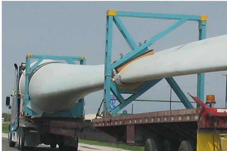
Abbildung 1.7.: Stapelbare Transportgestelle mit teilbarem Rahmen [12]
