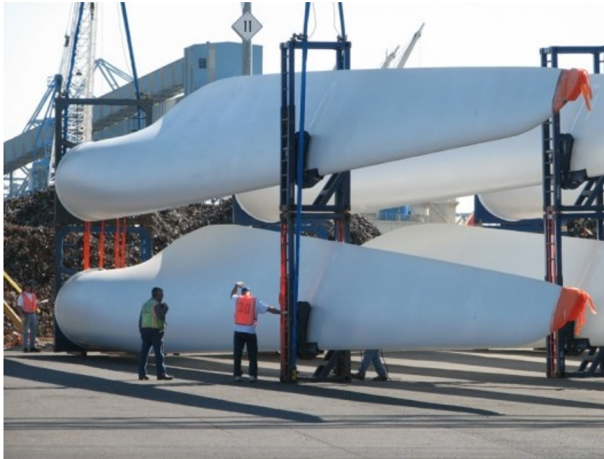
Abbildung 1.8.: Stapelbare Transportgestelle für kleine Rotorblätter [13]
