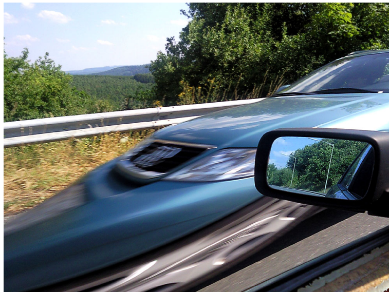
Abbildung 3.2.: Rolling-Shutter-Effekt bei einem schnell vorbeifahrenden Auto [ Axel1963 (Wikipedia) (2014)]
