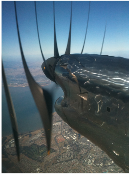
Abbildung 3.3.: Rolling-Shutter-Effekt bei einem Flugzeugpropeller [Richmilliron (Wikipedia) (2014)]
