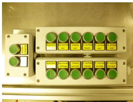
Abbildung 6.2.: Fernbedienung für den Handbetrieb
