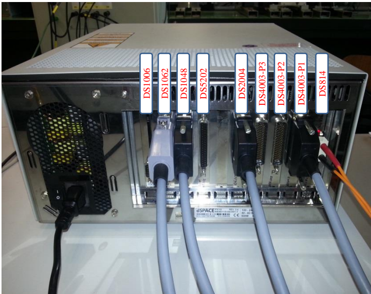
Bild 4.2: Fertiggestellte Schnittstellen am ACMC-System (vgl. [4])
