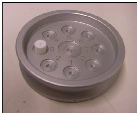
Abb. 5-2: Verwendeter Tiegel im Probensteller [26]
